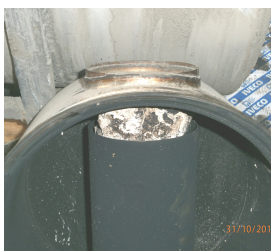
Des cristaux d'urée se déposent et finissent par obstruer l'échappement
